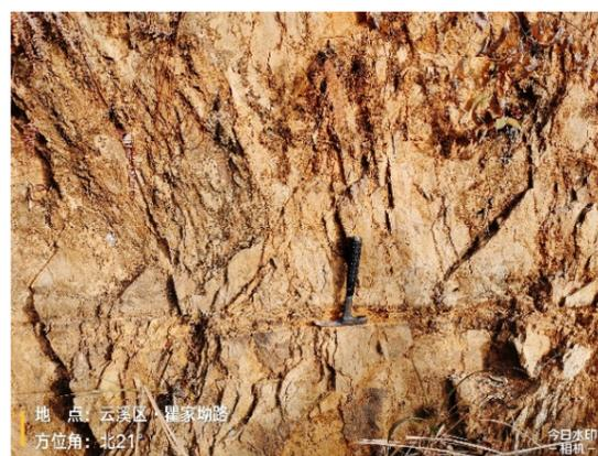
图 3.3.2-1 节理裂隙发育
