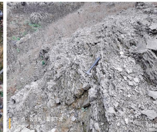
图 3.3.1-2 中风化板岩(极破碎)
