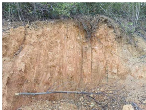
图 3.3.1-3 切坡揭露的含碎石粉质黏土
