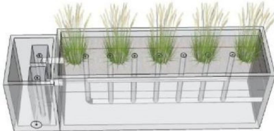
图 5.18 模块化人工湿地示意图
