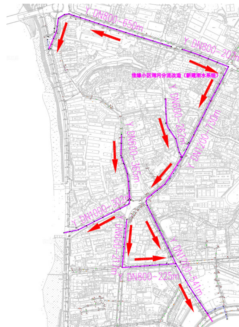
图 4.1 塍公塘片区雨污分流改造方案平面图
