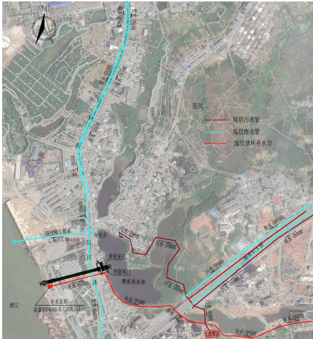
图 3.4 漕溪港周边排水管网现状
