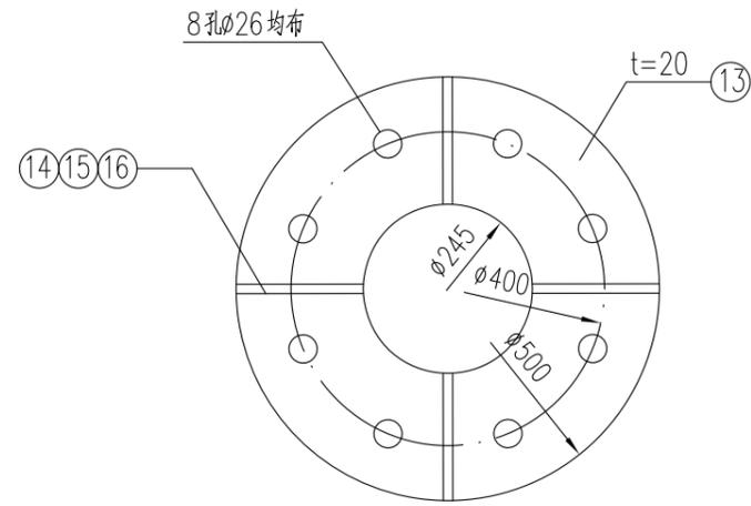
横臂连接法兰平面图
