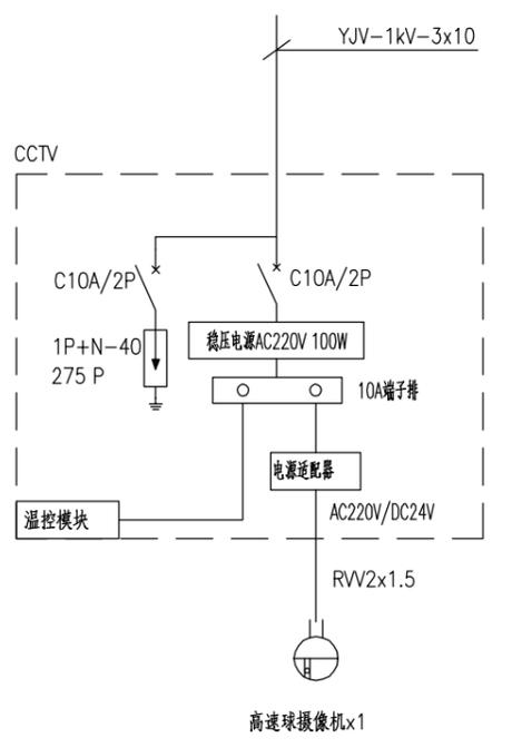
交通闭路电视监控系统配电系统图
