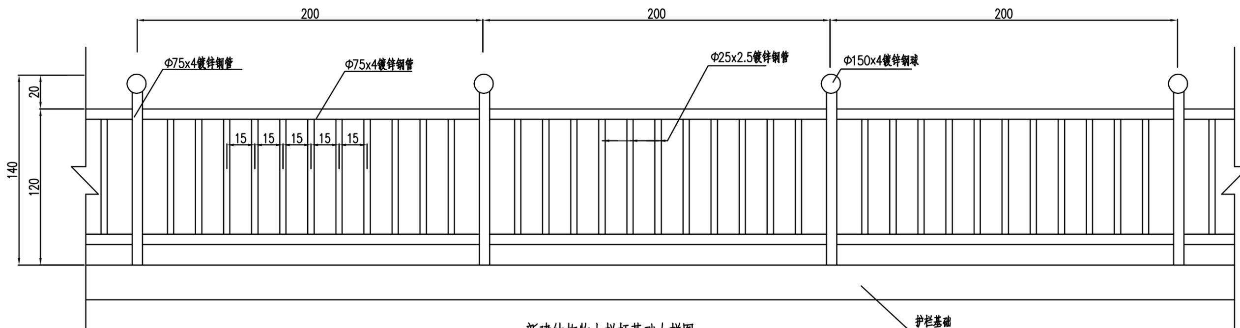
新建结构物上栏杆基础大样图
