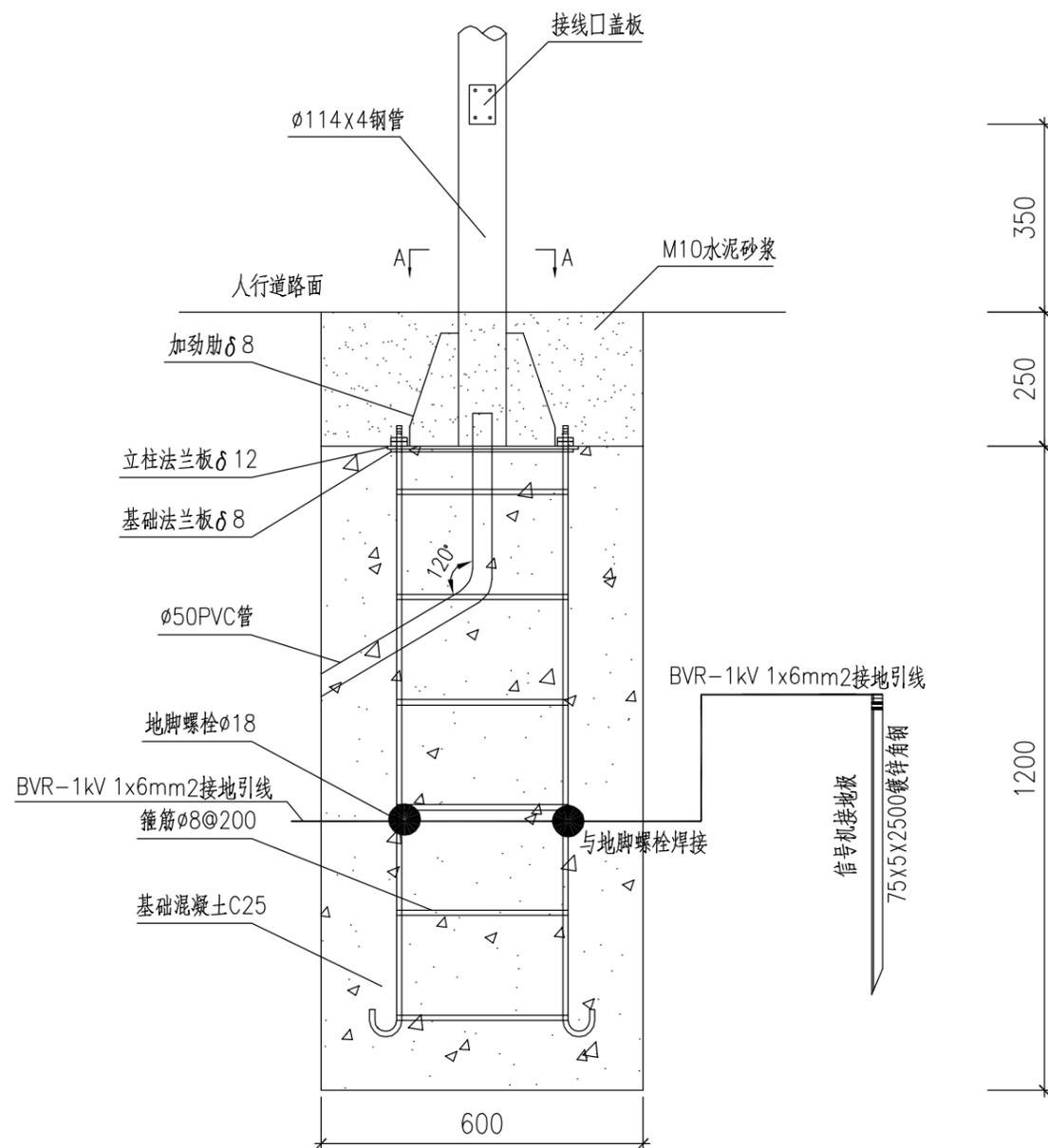
柱式信号灯杆基础大样图 1:10
