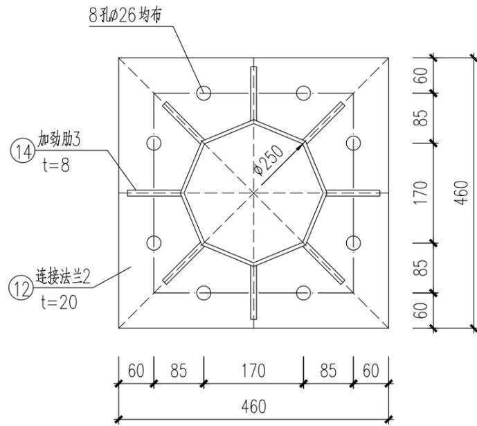
横臂连接法兰平面图
