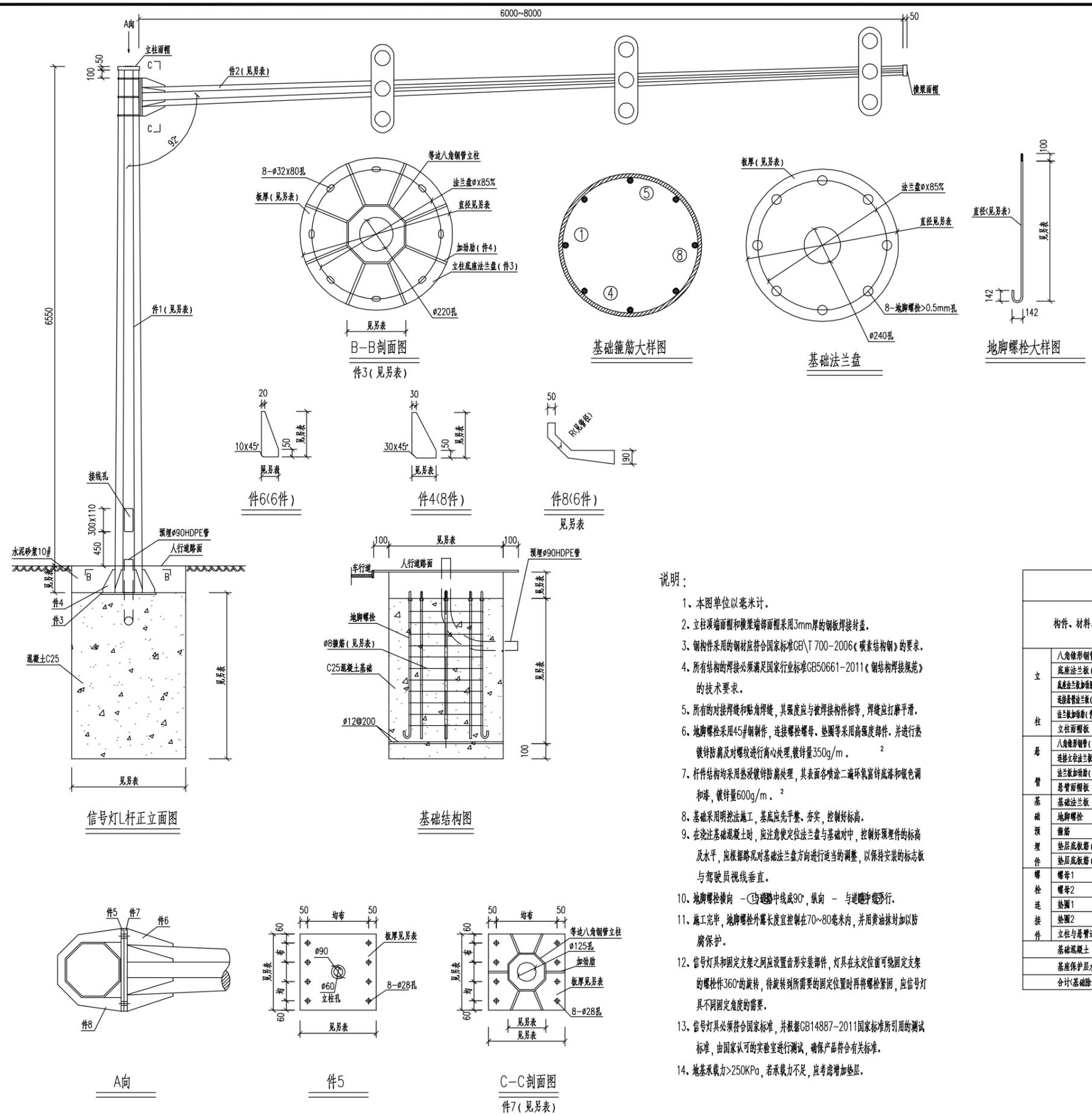
八角钢管悬臂式信号灯杆(L杆)钢结构连接件, 基层尺寸表
