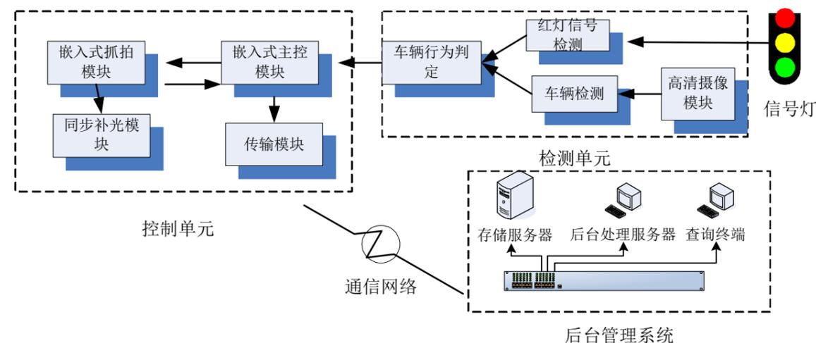
本系统由前端取证系统和后端处罚管理系统及数据传输系统构成。前端系统包括：车辆检测、图像采集、证据上传三大模块；后端系统包括：管理数据库、证据入库、证据录入、违章处理、辅助管理五大模块。前端系统通过网络与后端管理系统联接构成完整的电子警察系统。
