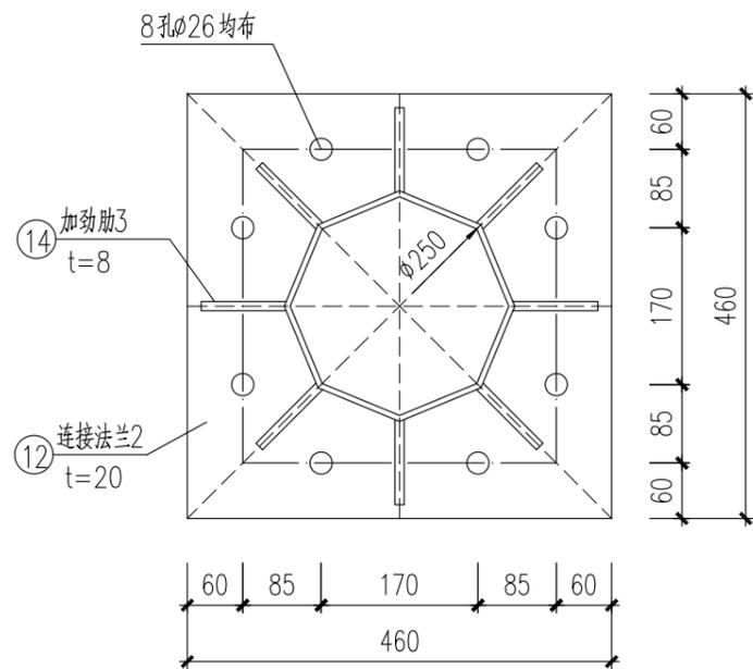
横臂连接法兰平面图
