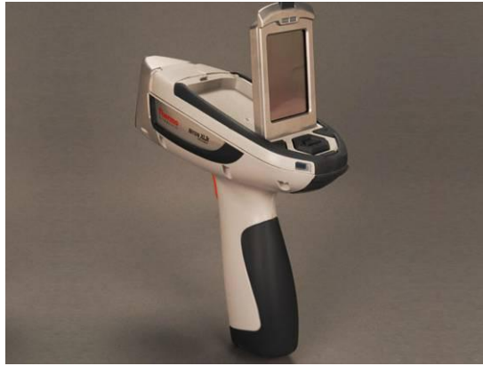
图 6-5 重金属快速检测分析仪
