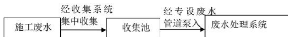
图 6-9 污水收集流程
